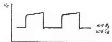
Bild 15. Impulsformverbesserung durch R_s und C_R
